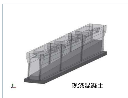
图 3b：现场设定形成坡度
